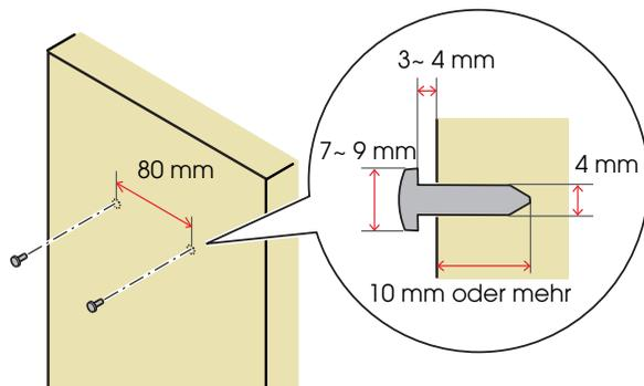
2. Entfernen Sie die angebrachten 2 Schrauben wie in der untenstehenden Abbildung gezeigt von dem Drucker.
