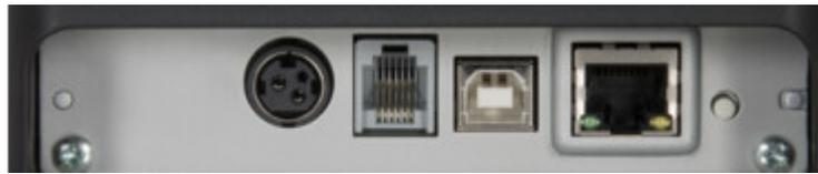
Sie haben die Wahl zwischen entweder einem seriellen Anschluss RS232 oder der Ethernet LAN Schnittstelle (siehe Abb.).
